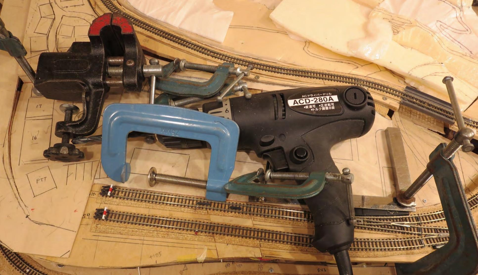
レイアウト基板の上に1mmの地形基板を正確に載せクランプや重しなどで磁石を固定する
