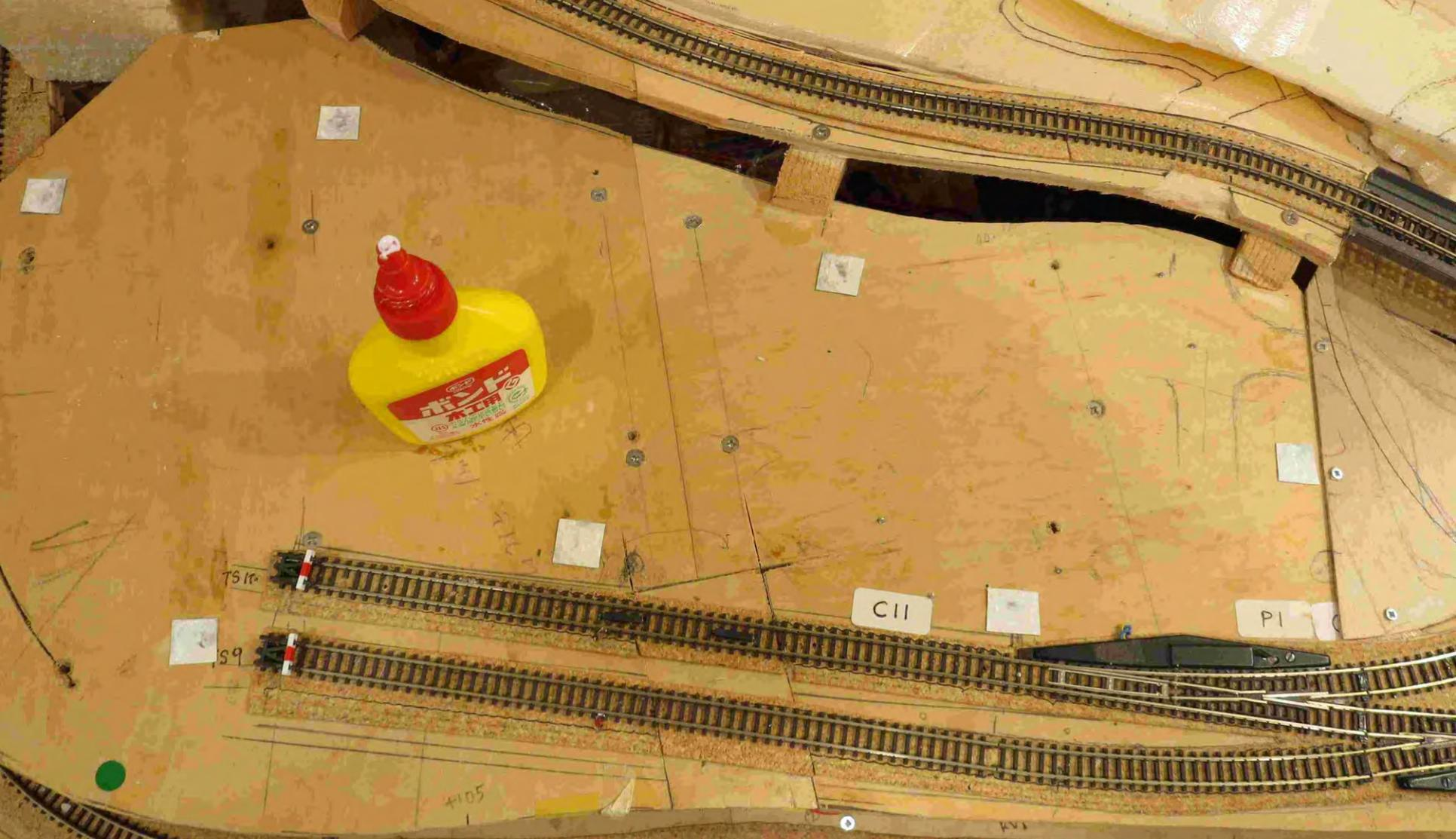
上部の1mmの地形板がバランスよく吸着出来る様に磁石を配置し磁石の裏側に全て接着剤を塗る
