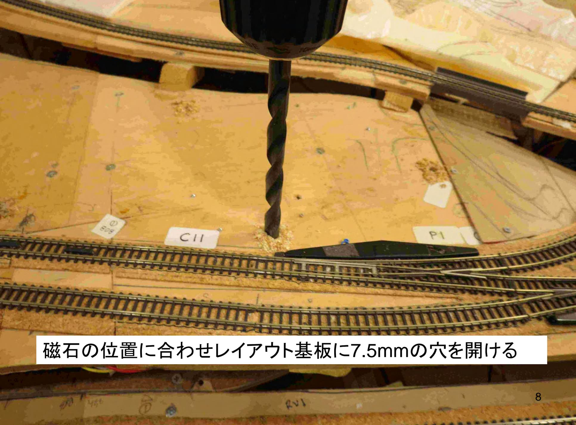
磁石の位置に合わせてレイアウト基板に7.5mmの穴を開ける
